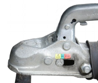
Anzeige gelb: Verschleißgrenzen in Werkstatt prüfen lassen
